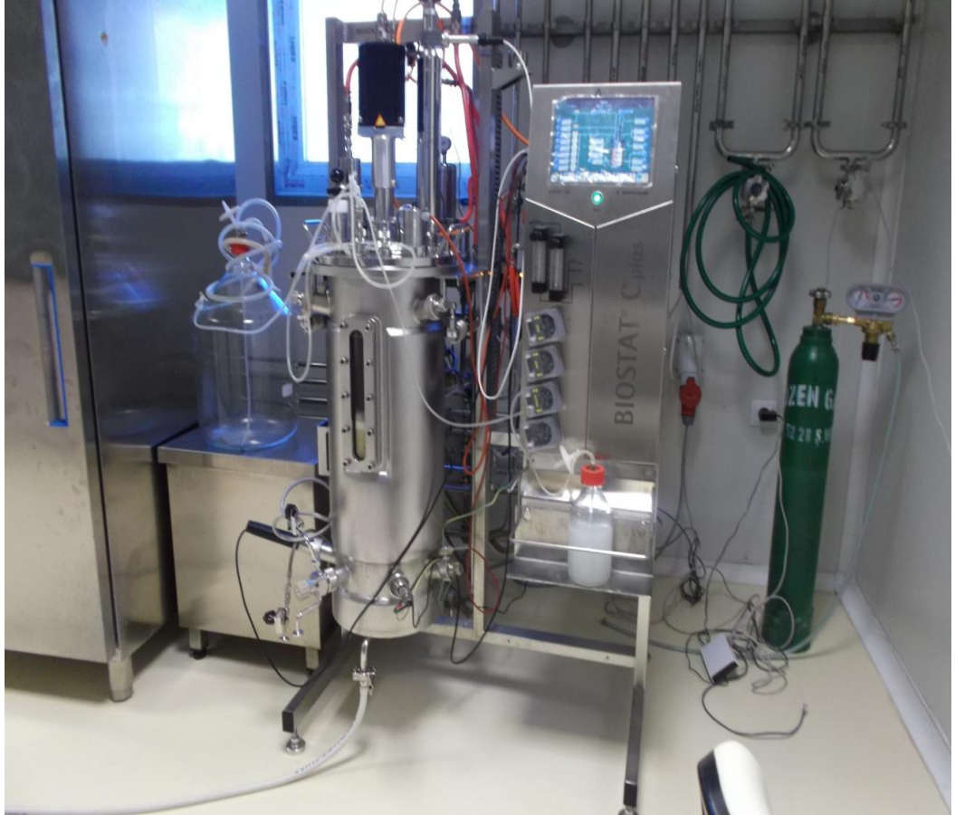
Resim 2.2.1. Brucella bakterisi üretiminde kullanılan bioreaktör
