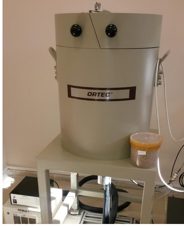
Resim 2.1 Ölçümlerde kullanılan Ortec marka koaksiyal HPGe detektör.
